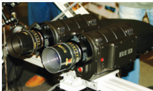
Стереосистема на основе камер Red One с объективами Optica Elite на стенде JC System Integration
